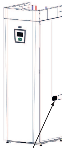
Anslutning höger sida (Använd främre uttag)
